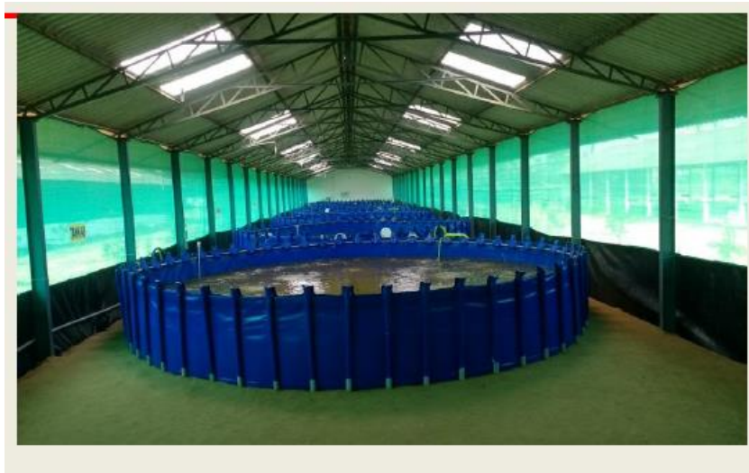
شکل ۶. نمایش یکی از مخازن پرورش پلی اتیلن فشرده ۵۰ مترمکعبی (Pradesh et al., 2016)
