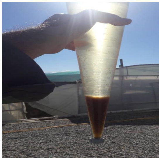
شکل ۲: اندازه گیری حجم فلاک با استفاده از کیف ایمهوف در اشکدر، یزد
